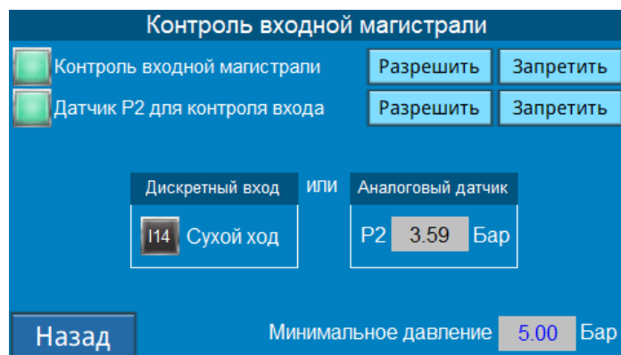
Рис. 16. Экран «Контроль входной магистрали»
